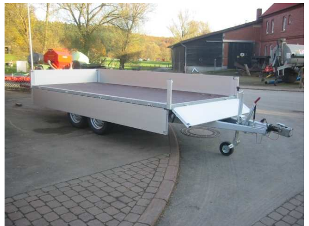
Bordwände und Eckrungen rundherum abklappbar und abnehmbar
