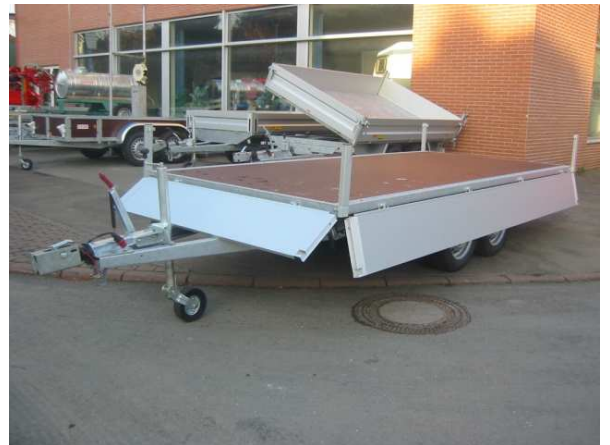
Bordwände und Eckrungen rundherum abklappbar und abnehmbar
